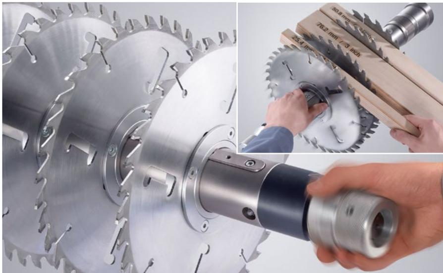
So einfach und komfortabel wie mit dem patentierten Schnellspannsystem Quickfix haben Sie vorher noch keine Maschine umgerüstet. Alles ist in kürzester Zeit erledigt: hydraulische Spannung lösen, Musterhölzer einlegen. Sägeblätter auf der Welle verschieben, hydraulisch spannen. Fertig. Und das ganz ohne Aufsteckbüchse, Zwischenringe und Werkzeuge.
