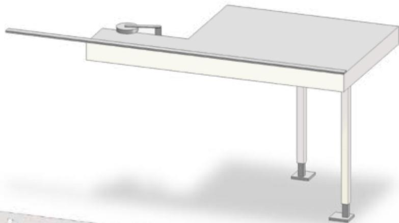
Übergabe zur halbautomatischen Beschickung der Keilzinken-Pressen, Typ EKR 150 / 500 / 1000. Ein-Kanal-Pressen, linke Festkante.
