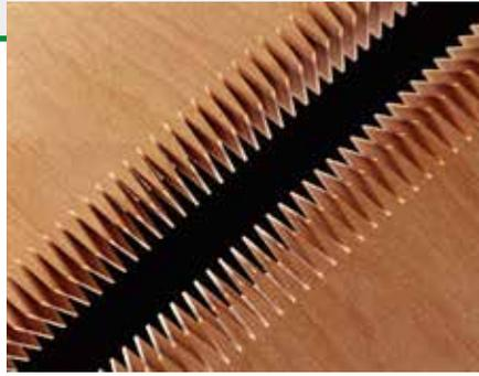
Durch den vorschubstarken, frequenzgeregelten Frästischmotor garantiert diese Anlage ein gleichmäßiges, präzises Schnittbild über die gesamte Paketbreite.
