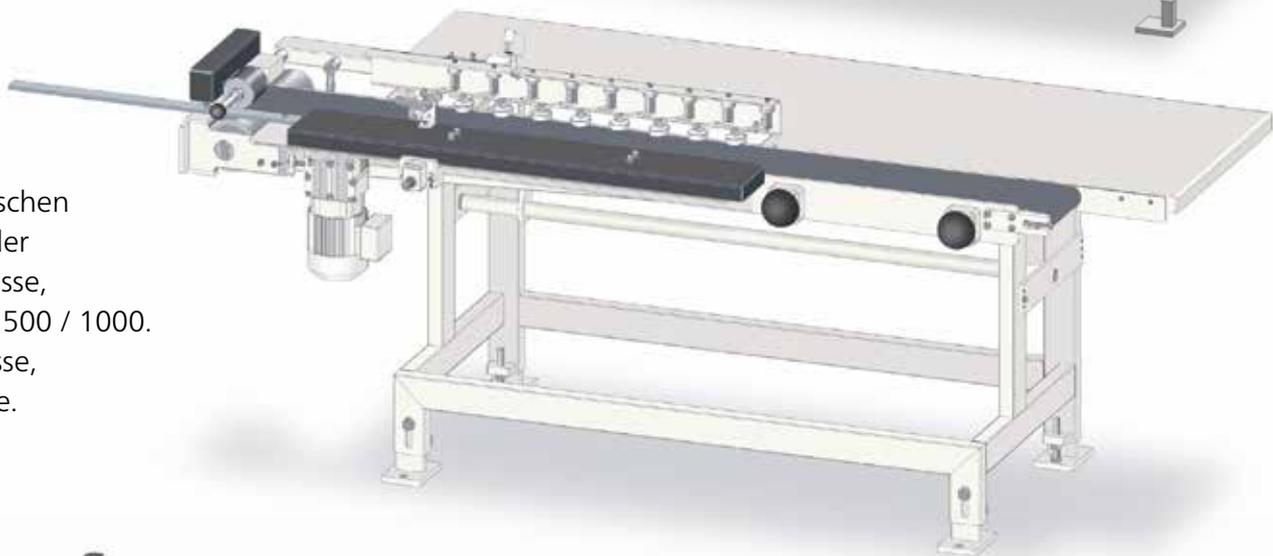
Übergabe zur halbautomatischen Beschickung der Keilzinken-Pressen, Typ EKR 150 / 500 / 2500. Zwei-Kanal-Pressen, rechte Festkante.
